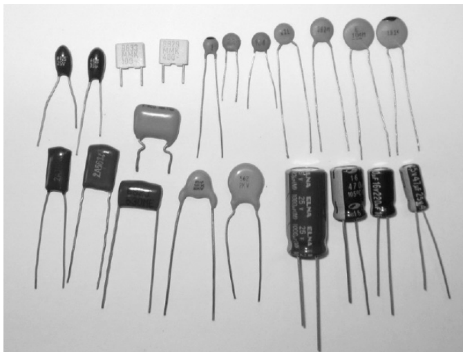
รูปที่ 4.1 ตัวอย่างตัวเก็บประจุที่ใช้งานทั่วไป
